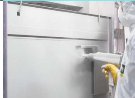
elektrostatik boya electrostatik paint
